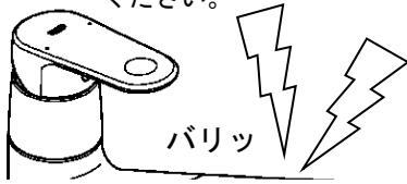
凍結破損で漏水し、家財などを濡らす財産損害発生のおそれがあります。
