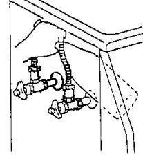
給水・給湯管の外れや、破損による漏水の原因となります。
